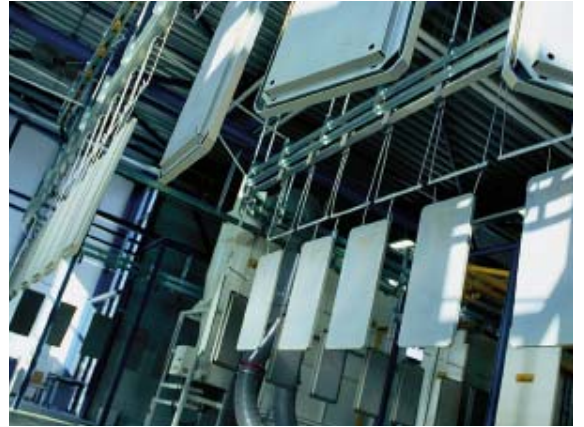
Deuren en panelen voor kantoorkasten in de lakkerij
